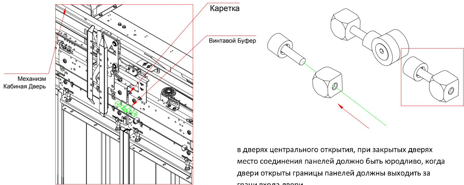
в дверях центрального открытия, при закрытых дверях место соединения панелей должно быть юродливо, когда двери открыты границы панелей должны выходить за грани входа двери.
